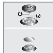
Для корректного функционирования запальных свечей и термопар они должны быть всегда хорошо очищенными. Почаще проверяйте их и, при необходимости, очищайте влажной тряпкой. Присохшие остатки можно удалить деревянной зубочисткой или иголкой.
