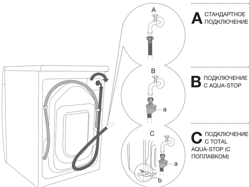
☼ Для бесперебойной работы машины давление воды в водопроводной сети должно быть в пределах 0,05–0,8 МПа (0,5–8 бар). Минимальное давление можно определить, измерив количество вытекающей воды. За 30 секунд из полностью открытого крана должно вытекать 1,2 литра воды.
