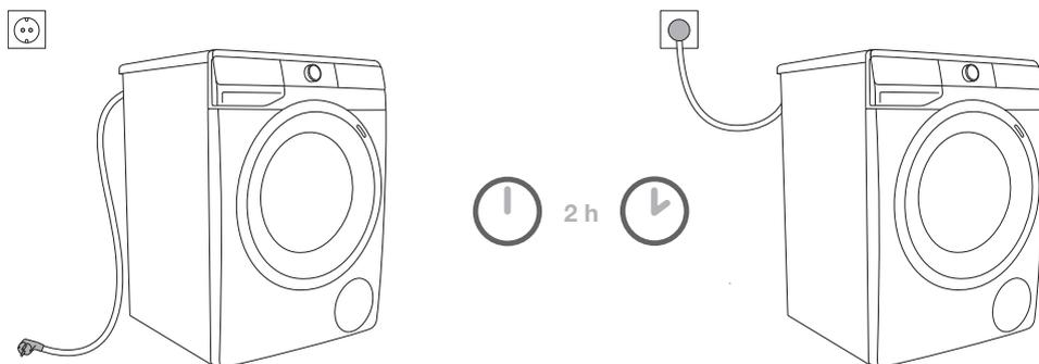
**⚠ Перед подключением к электросети оставьте стиральную машину на 2 часа при комнатной температуре.**
