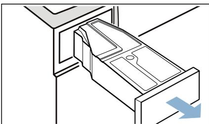
7. Влейте в контейнер для конденсата бутылку оригинального средства для ухода за прибором и прим. 1 ½ л теплой водопроводной воды.
