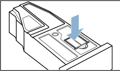
12. Задвиньте резервуар для конденсата до фиксации.
