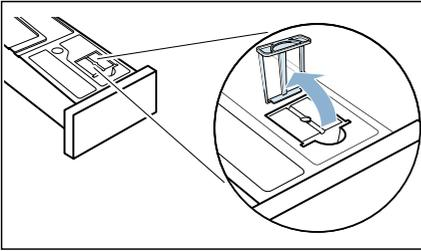
2. Выньте вставленную пробку из углубления резервуара для конденсата.
