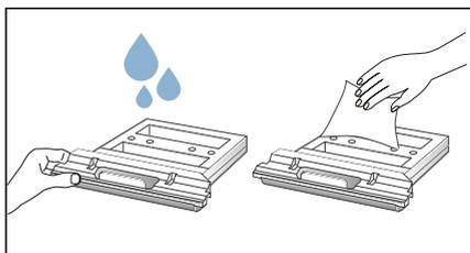
8. Протрите отверстие в приборе мягкой влажной тряпочкой.
