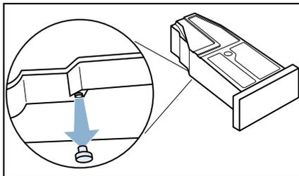
9. Снова поверните резервуар для конденсата на 180° и установите пробку в углубление на верхней стороне резервуара для конденсата.
