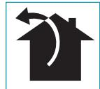
Tässä versiossa savut ja höyröt johdetaan ulkotilaan poistoputken kautta. Tätä varten liesituulettimen ilmanpoistoliitos on liitettyä putkeen, jossa on ulkoinen poistouukko.
