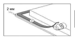
Снимите защитную ленту (3) и уложите уплотнение (2) по внешнему краю стеклянной поверхности так, чтобы оставался зазор ок. 2 мм.
