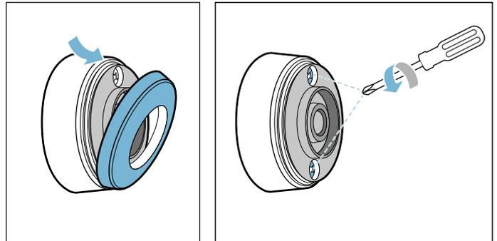
2. Откройте заглушку датчика температуры. Выньте батарейку из нижней части корпуса и установите новую батарейку (при этом следите за правильной установкой полюсных выводов батарейки).
