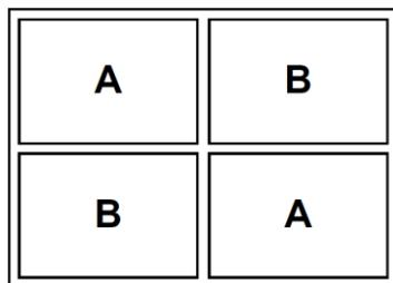
Если мощность, установленная на обеих зонах группы, превысит предельно возможное значение, то система управления энергопотреблением автоматически уменьшит мощность одной из этих варочных зон. Дисплей этой зоны начнет мигать, после чего ее уровень мощности автоматически уменьшится до максимально доступного уровня.
