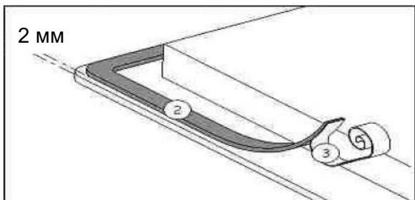
Снимите защитную ленту (3) и уложите уплотнение (2) по внешнему краю стеклянной поверхности так, чтобы оставался зазор ок. 2 мм.
