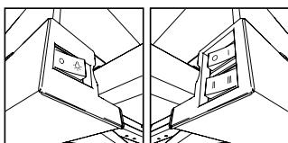
Работа вытяжки контролируется при помощи совмещенного переключателя.
