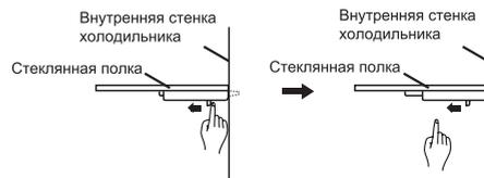
Чтобы снять стеклянную полку, нажмите двумя руками на подвижный штифт, находящийся ниже самой полки, и одновременно подтолкните её вовнутрь.
