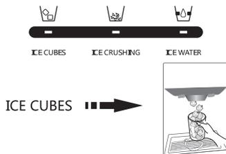
Нажмите кнопку «**ICE CRUSHING**», при этом отобразится индикатор . Далее нажмите и удерживайте пушкран, для наполнения стакана колотым льдом.
