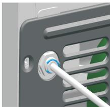
Установите предохранительный клапан на место
