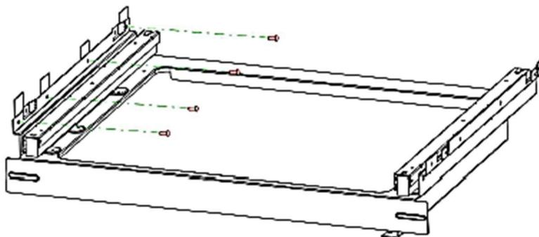
Б. Метод крепления к полке снизу.
