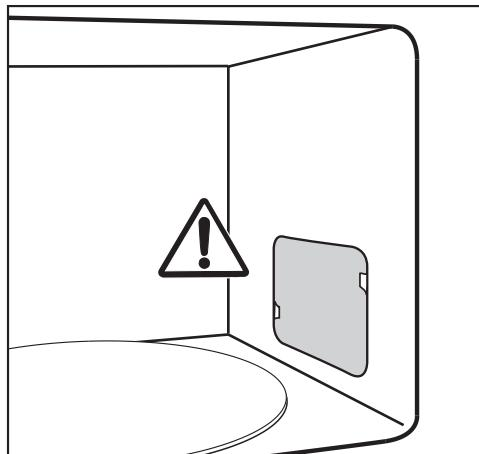
Не удаляйте специальную защитную пластину, расположенную в рабочей камере перед отверстием выхода микроволн, а также плёнку с внутренней стороны дверцы.
