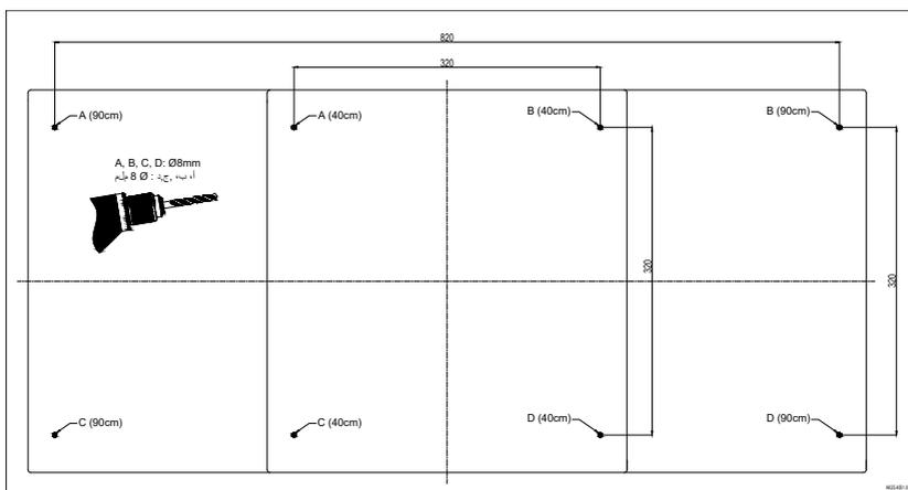
Забейте с помощью молотка в просверленные отверстия 4 дюбеля диаметром 8 мм, входящие в комплект монтажных принадлежностей. Не повредите дюбеля. Затем, продев шурупы 4x40 YSB через потолочные крепежные детали подвесного троса, закрепите его на дюбеле вместе с потолочной подвесной пластиной. Каждый трос закрепите на потолочном креплении при помощи стопорного элемента (иллюстрация 3).
