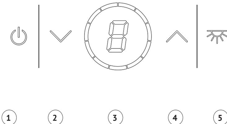
1. Включение/выключение мотора. Используется для запуска и остановки мотора вытяжки.
