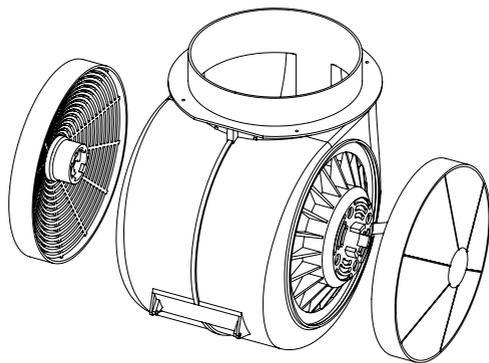
**ПРИМЕЧАНИЕ! УГОЛЬНЫЕ ФИЛЬТРЫ НЕОБХОДИМЫ ПРИ РАБОТЕ ВЫТЯЖКИ В РЕЖИМЕ РЕЦИРКУЛЯЦИИ.**
