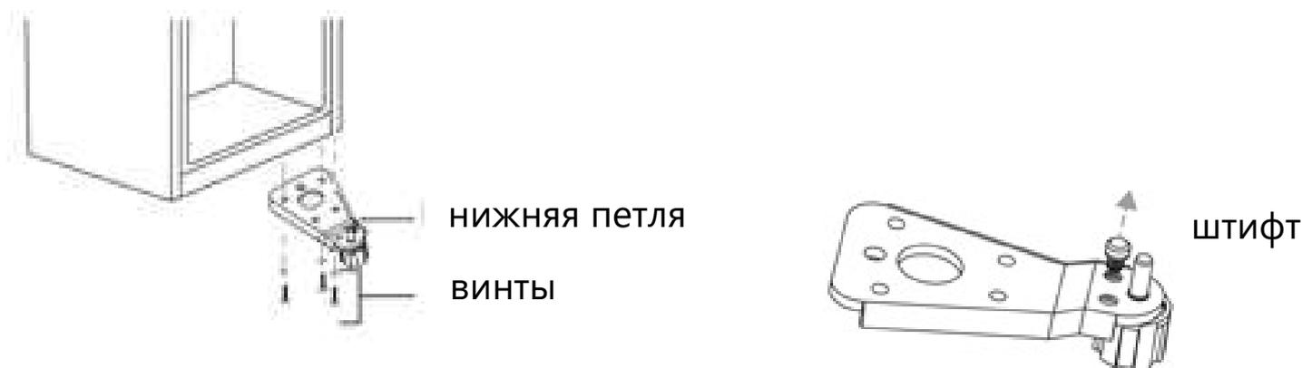
4. Снимите шайбу и гайку, которые крепят вал штифта к правому отверстию на нижней петле, затем снимите вал.
