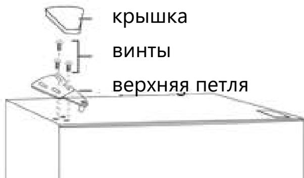
13. Снимите заглушки левого отверстия, открутите болты и снимите заглушки правого отверстия.
