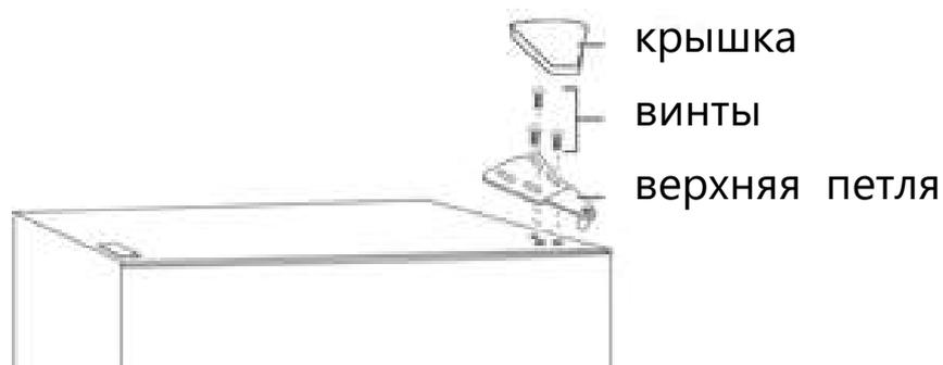
2. Снимите дверь морозильной камеры.
