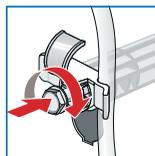
Зафиксируйте сетевой кабель в креплениях. Вставьте винты и затяните их.
