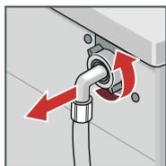
Снимите шланг со спинки прибора.
