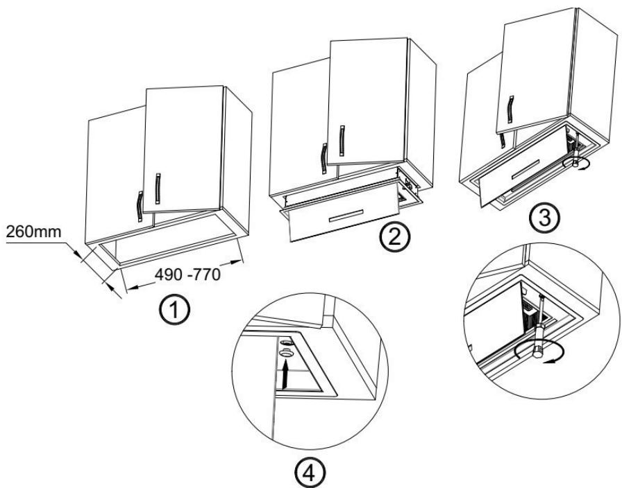
Установка вытяжки в мебельный шкаф.
