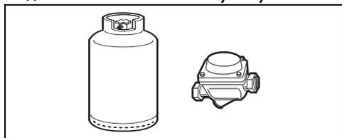
Используйте регулятор давления и выполните подключение к баллону с соблюдением требований, установленных действующими нормами.
