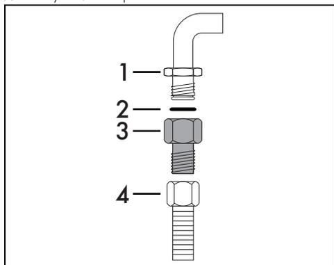
Аккуратно привинтите фитинг 3 к газовой патрубку 1 (резьба 1/2 дюйма ISO 228-1) прибора, проложив прокладку 2 из комплекта поставки. Нанесите изоляционный материал на резьбу патрубку 3, а затем заверните гибкий стальной шланг 4 на патрубке 3.
