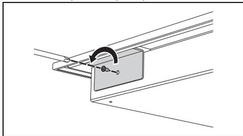
7. Открутите крепежные винты каждой конфорки и снимите пластины.
