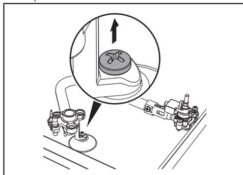
2. Снимите суппорт горелки и соответствующую трубку подачи газа.
