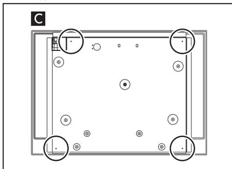
Чтобы правильно закрепить варочную панель на тумбе для встраивания, привинтите крепежные кронштейны в специальные намеченные отверстия.
