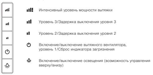
В зависимости от модели и оснащения конструкция прибора может в деталях отличаться от описанного стандартного исполнения.
