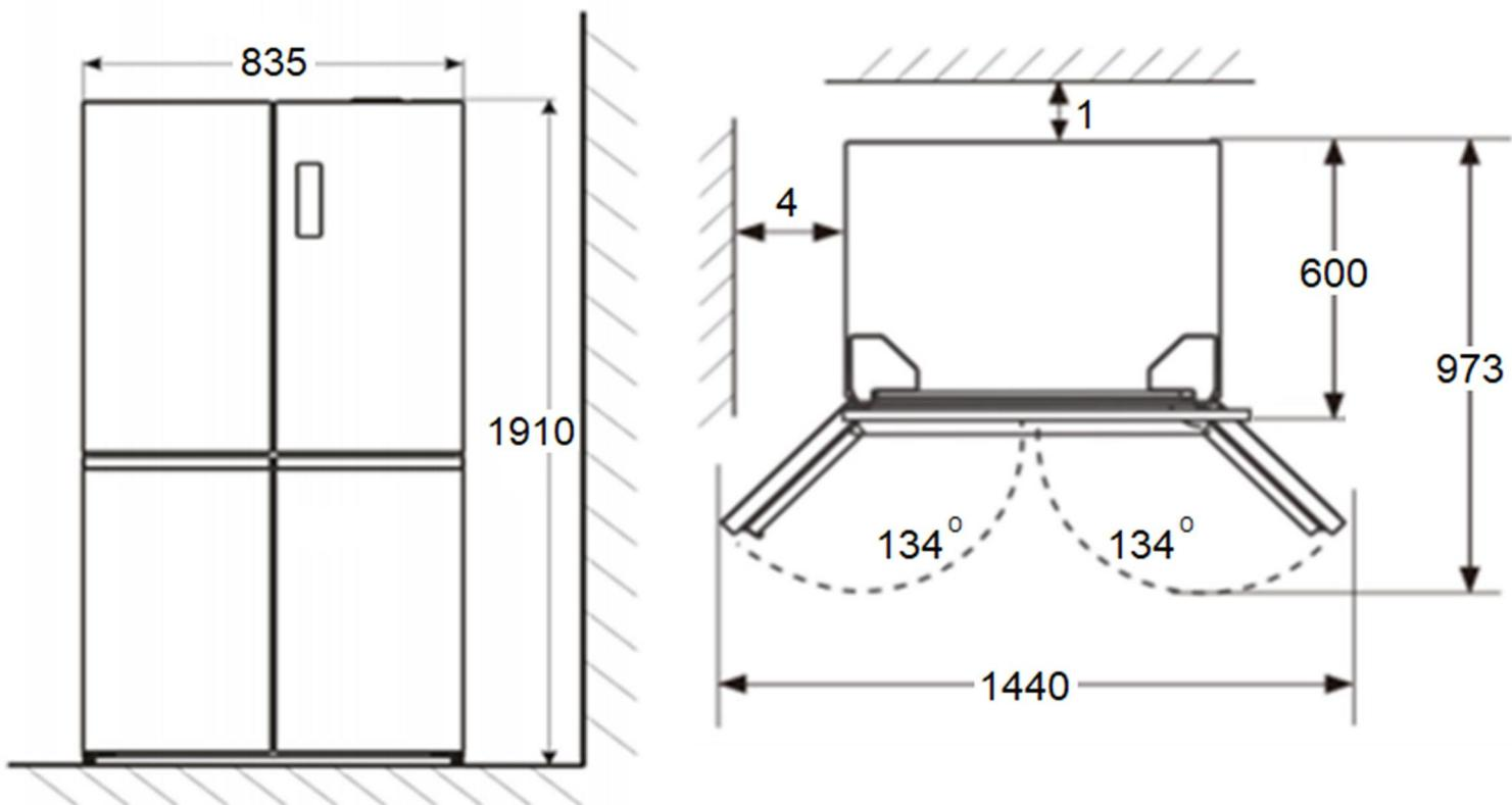
Выравнивание холодильника необходимо для устранения вибрации. Если уровень холодильника не отрегулирован должным образом во время установки, двери могут неплотно закрываться, что может привести к проблемам с охлаждением, замораживанием и поддержанием уровня влажности.
