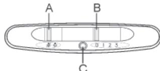
Omkopplare A: BELYSNING; läge : belysning påslagen; läge : belysning påslagen.
