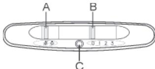
Prepínač A: SVETLO; poloha : svetlo vypnuté;; poloha : svetlo zapnuté.
