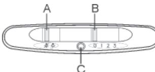
Sklopka A: SVJETLO; položaj : svjetlo ugašeno; položaj : svjetlo upaljeno.
