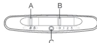
Comutador A: LUZ: posición : luz apagada; posición : luz encendida
