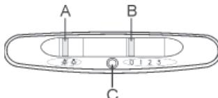
Tast A: LYSET: position : lyset slukket; position : lyset tændt.
