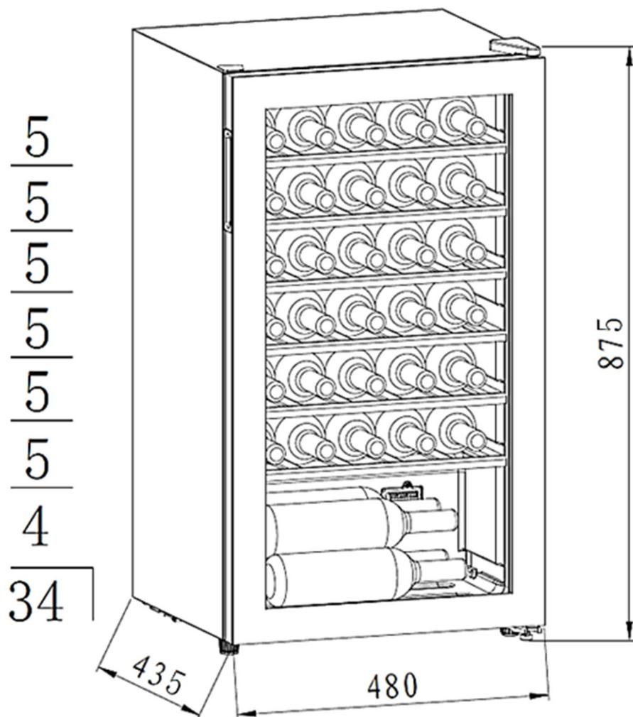
Винный шкаф снабжен съемными полками для удобного хранения вина. Вместимость данной модели винного шкафа составляет 34 бутылки (стандартные бутылки формы «Бордо», объем 750 мл).
