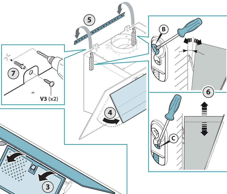
IT - Installazione valvola di non ritorno (3) e montaggio tubo d'aspirazione (4).
