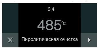
По завершении пиролитической очистки раздается сигнал. На дисплее появляется сообщение. После того, как прибор остынет, вытрите оставшийся в рабочей камере нагар влажной тряпочкой.
