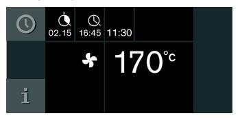
Прибор переходит в состояние ожидания. На дисплее отображается режим работы, температура, время приготовления и время окончания. Прибор запускается в рассчитанное время и выключается по истечении времени приготовления.
