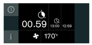
После окончания времени приготовления прибор выключается. Мигает символ ( и выдается звуковой сигнал. Он прекращается, как только Вы прикоснетесь к символу ✓, откроете дверь прибора или установите переключатель функций на 0.
