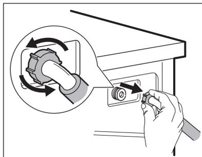
3. При помощи зубной щетки произведите очистку фильтра клапана с задней стороны прибора.
