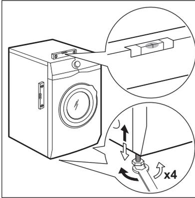
1. Установите прибор на ровный твердый пол. Прибор должен стоять ровно и устойчиво. Позаботьтесь о том, чтобы прибор не касался стен или других приборов или предметов мебели; убедитесь в циркуляции воздуха под прибором.
