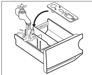
4. Установите дозатор моющих средств на направляющие и закройте его. Запустите программу полоскания без белья в баке.
