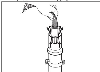
4. Путем подключения к стояку с впускным отверстием - Подсоедините сливной шланг непосредственно к сливной трубе. См. рисунок.
