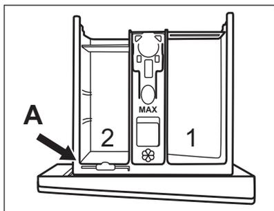
2. Также для использования жидких моющих средств/ добавок или отбеливателя: Извлеките перегородку для моющих средств из положения А и вставьте ее в положение В.
