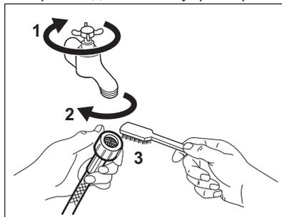
2. Снимите наливной шланг с прибора, ослабив зажимную гайку.
