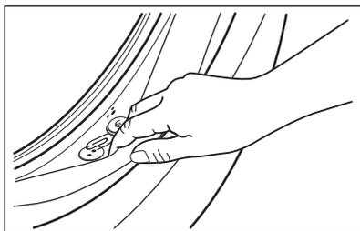
Регулярно проверяйте состояние уплотнителя и удаляйте все предметы с его внутренней стороны.
