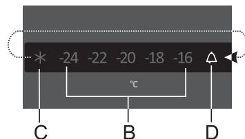
При превышении допустимой температуры в приборе включается прерывистый звуковой сигнал и мигает индикатор **D**.
