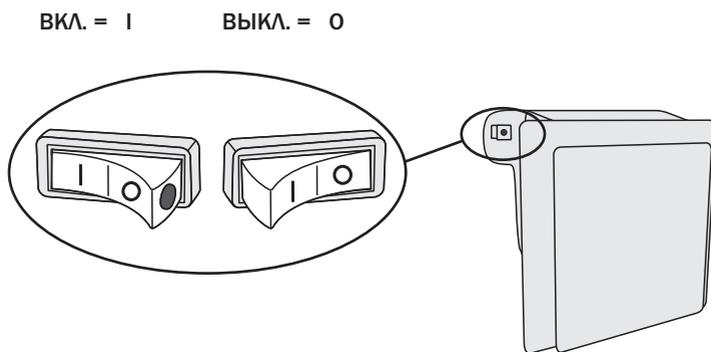
Когда ионизатор воздуха включен, на выключателе видна красная точка.
