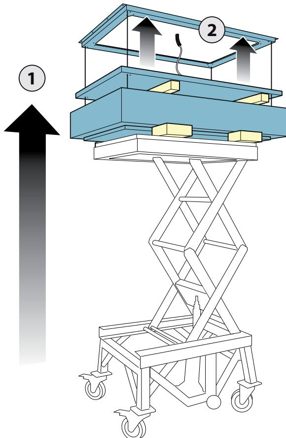
IT - Fissaggio staffa di fissaggio a soffitto (2). Installazione soffitto in cemento armato (A), Installazione con soffitto in laterizio (B).
