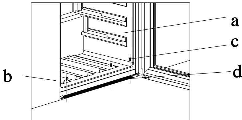
1. Bauen Sie den Weinkühler (a) in den korrekten Position in den Schrank (b) ein
