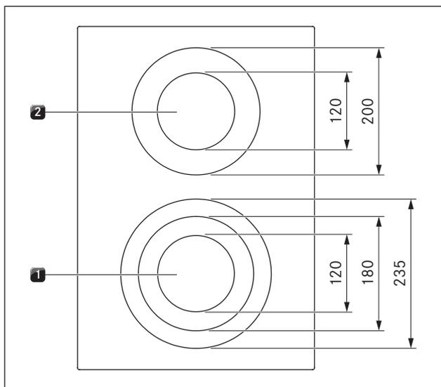
рис. 4.5 Конструкция варочной панели РКС3 и размер конфорок
