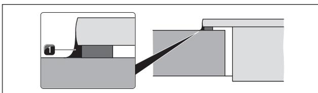
рис. 5.28 Силиконовый герметик для навесного монтажа
