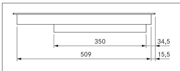
рис. 3.3 Размеры РКС3, вид сбоку
