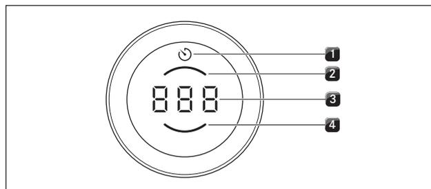
рис. 4.3 Элементы индикации поворотной ручки управления
