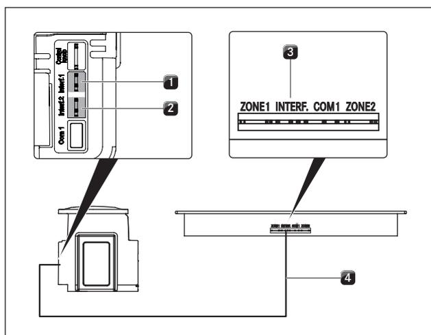
рис. 5.24 Установка соединения между вытяжкой и варочными панелями
