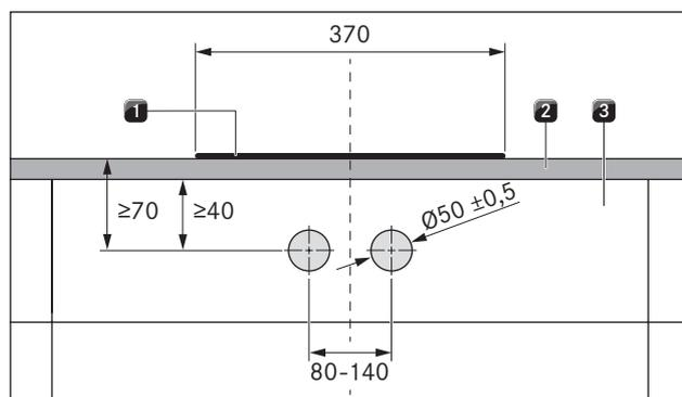
рис. 5.10 Схема отверстий в передней панели варочных панелей
