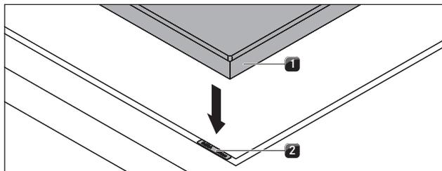
рис. 5.17 Варочная панель и пластины для регулировки высоты
