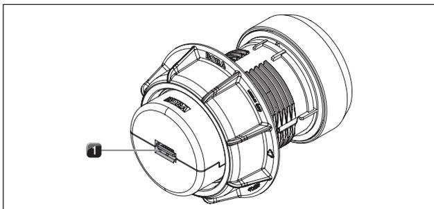
рис. 5.20 Задняя сторона поворотной ручки управления с подключенным разъемом
