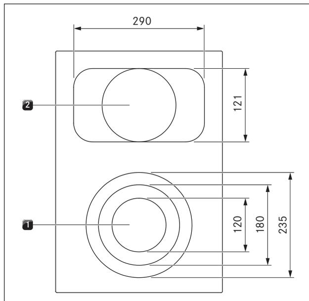
рис. 4.6 Конструкция варочной панели РКСВ3 и размер конфорок
