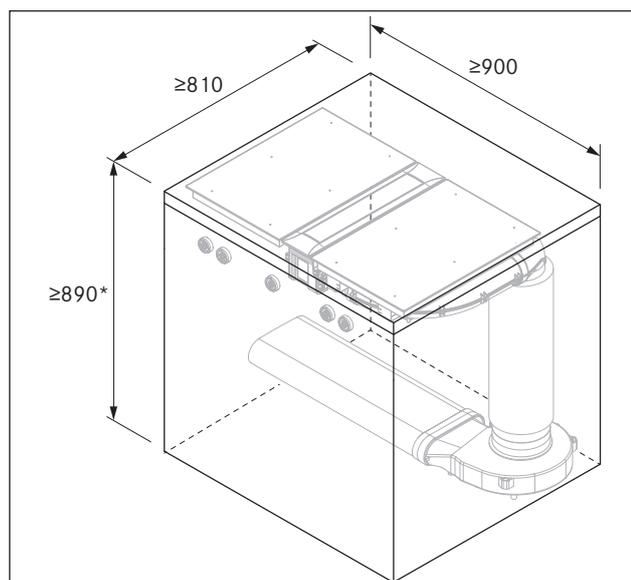
рис. 5.2 Минимальные монтажные размеры РКАЗ/РКАЗAB стандартной конструкции
