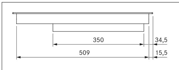
рис. 3.6 Размеры РКСВ3, вид сбоку
