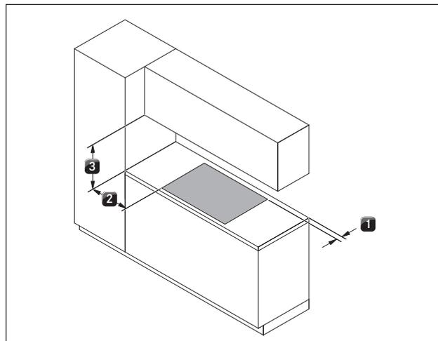
рис. 5.19 Минимальные расстояния при монтаже с поворотом на 180°
