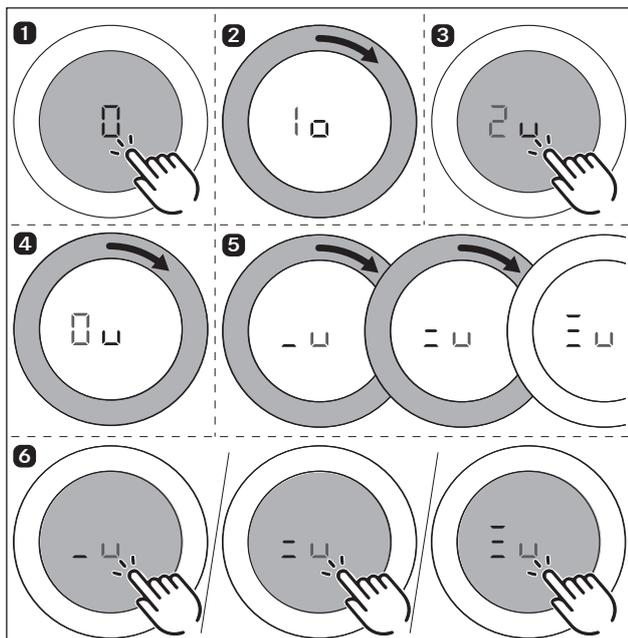
рис. 6.10 Активация функции поддержания тепла (PKC3, PKCB3, PKCH3)
