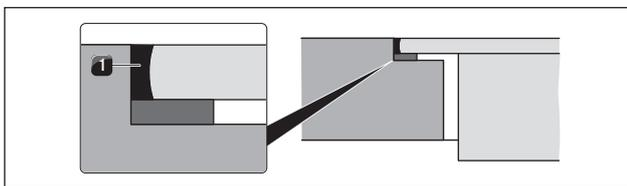
рис. 5.27 Силиконовый герметик для монтажа заподлицо
