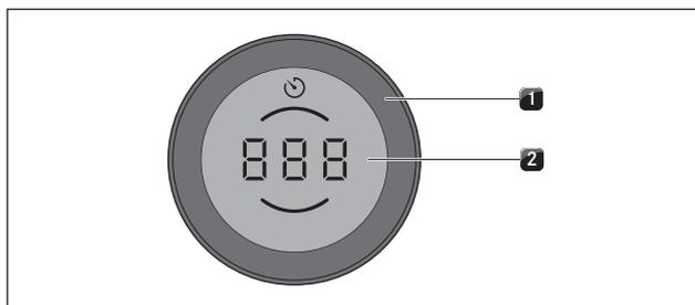
рис. 4.2 Элементы управления поворотной ручки управления
