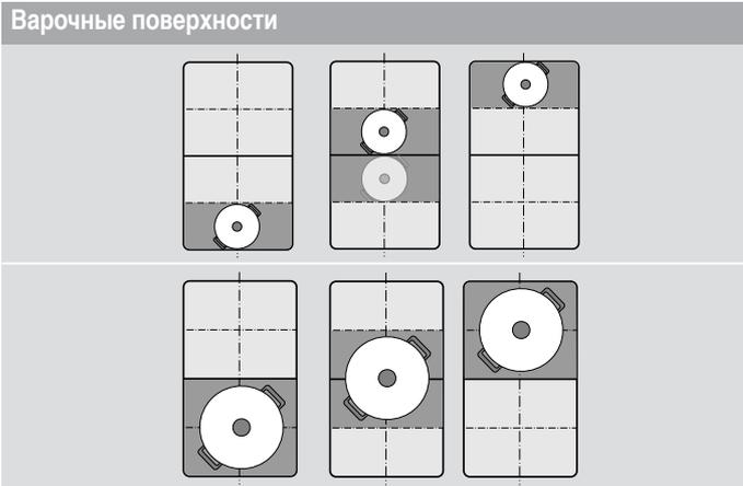
Таким образом, посуда в ходе приготовления может быть перемещена на другую варочную поверхность с другой ступенью нагрева:
