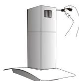
2. Выдвиньте внутреннюю часть короба и закрепите её на крепежной скобе.
