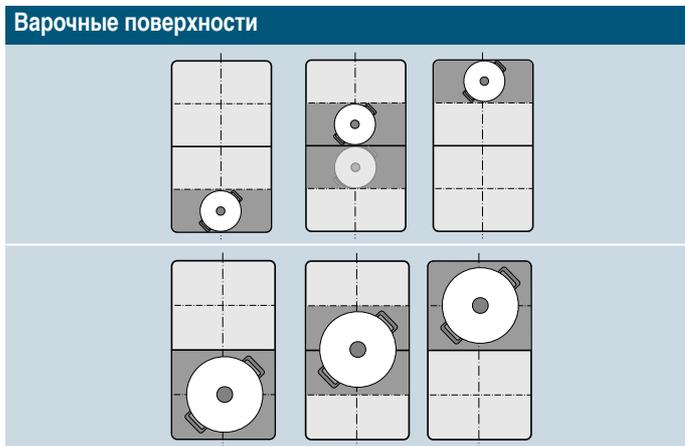
Таким образом, посуда в ходе приготовления может быть перемещена на другую варочную поверхность с другой ступенью нагрева:
