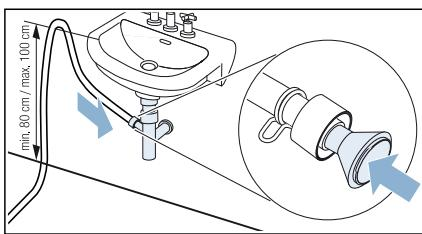
Місце з'єднання зафіксуйте за допомогою затискача шланга (діапазон затискання 12–22 мм, спеціалізований магазин).
