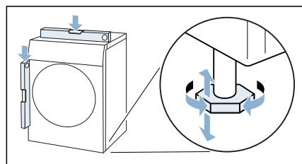
3. При потребі вирівняйте прилад знову, обертаючи ніжки приладу. Тепер можна підключити прилад.
