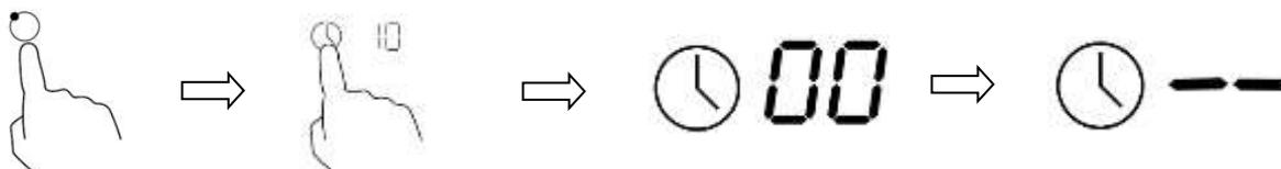
6. По истечению установленного времени выбранная варочная зона автоматически отключится. Раздастся однократный звуковой сигнал, на дисплее загорится «- -».
