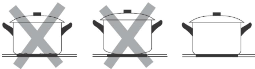
Убедитесь, что поверхность дна посуды гладкая, плотно прилегает к поверхности варочной панели, а диаметр дна соответствует диаметру варочной зоны. При использовании посуды с дном большего диаметра будет расходоваться большее количество энергии. Если Вы используете посуду с меньшим диаметром дна, то эффективность использования энергии может быть меньше, чем ожидалось. Посуда с диаметром дна менее 140 мм может быть не распознана прибором. Всегда ставьте посуду по центру варочной зоны.
