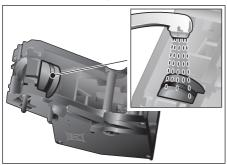
■ Тщательно очистите соединительные фиксаторы заварочного блока.
