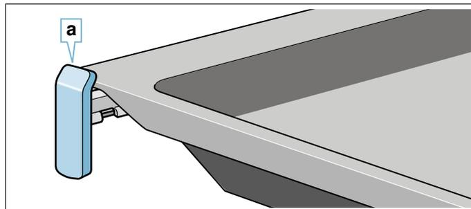
Выдвигные направляющие фиксируются при полном выдвигании. Это облегчает установку принадлежностей в прибор. Для расфиксирования необходимо слегка нажать на выдвигные направляющие при задвигании их обратно в рабочую камеру.
