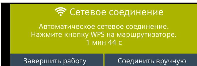
Прибор готов к ручному установлению сетевого соединения.
