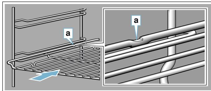
При установке противня следите за тем, чтобы фиксирующий выступ **a** находился сзади и был обращён вниз. Скошенный край противня **b** должен быть обращён вперёд к дверце прибора.
