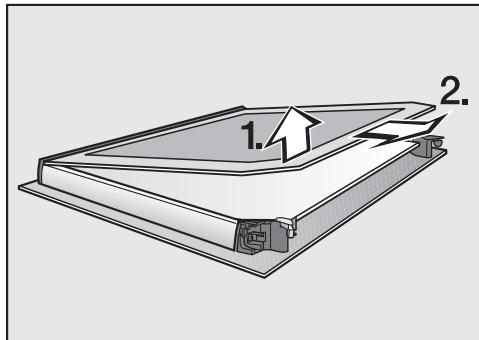
■ Приподнимите **слегка** внутреннее стекло дверцы и вытащите его из пластмассовой планки.
