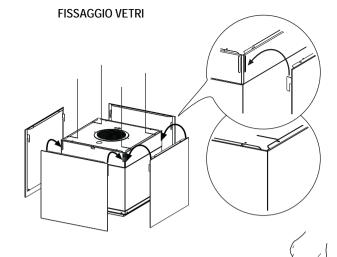
Fissare da sopra i 4 Vetri con le Viti 12b e Rondelle 12d in dotazione verificando di mantenere il livellamento tra di essi.
