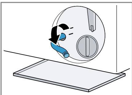
7. **! ОСТОРОЖНО - Опасность ошпаривания!** Во время стирки при высокой температуре раствор моющего средства сильно нагревается.
