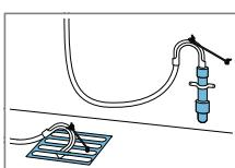
Зафиксируйте и закрепите сливной шланг скобой.
