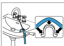
Зафиксируйте и закрепите сливной шланг скобой.
