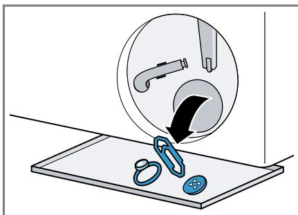
Крышка насоса состоит из двух деталей, которые можно разобрать при очистке.
