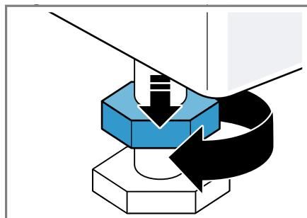
2. Выравнивание прибора осуществляется путем вворачивания и выворачивания регулируемых ножек. Проверьте выравнивание по уровню.
