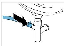
Зафиксируйте соединение хомутом (24-40 мм).
