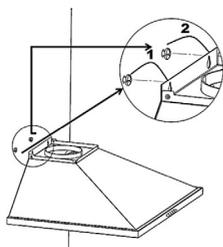
1. Разметьте и просверлите два отверстия для крепления вытяжки (диаметр отверстий - 8 мм).
