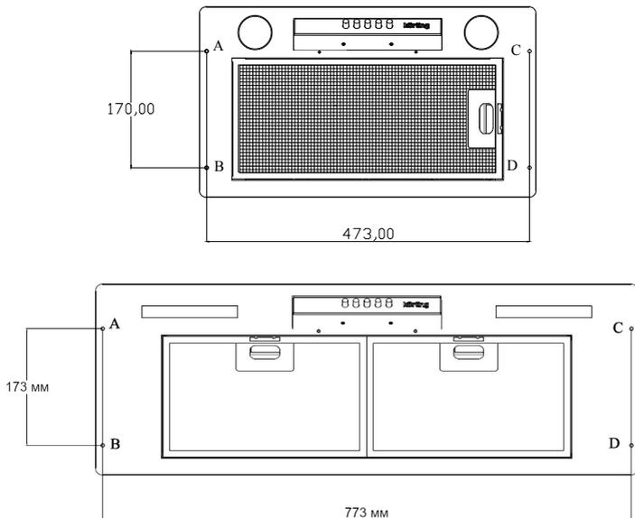
2. Для монтажа вытяжки просверлите отверстия в мебели при помощи сверла диаметром 3 мм согласно точкам А,В,С,Д.
