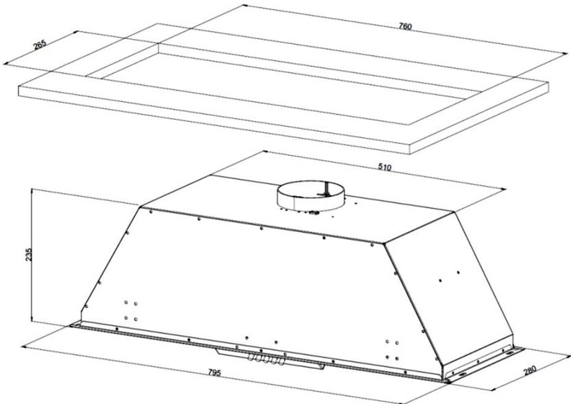
1. Подготовьте мебель под монтаж вытяжки согласно размерам на схеме встраивания.
