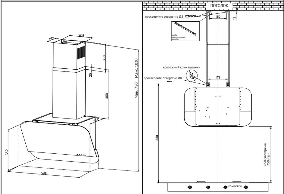
1. Для установки вытяжки на стену используйте крепежные крюки и крепежные элементы поставляемые в комплекте. Разметьте и просверлите два отверстия для установки крепежных крюков. Установите крепежные крюки.
