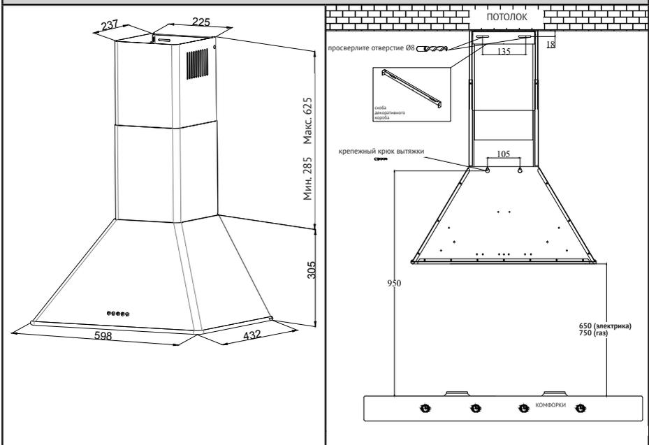
1. Для установки вытяжки на стену используйте крепежные отверстия и крепежные элементы поставляемые в комплекте. Разметьте и просверлите два отверстия для установки корпуса вытяжки.
