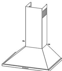
4. Установите телескопические короба на купол и зафиксируйте их по бокам при помощи двух саморезов.
