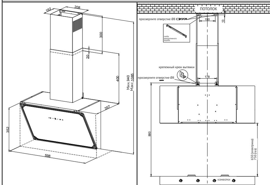
1. Для установки вытяжки на стену используйте крепежные крюки и крепежные элементы поставляемые в комплекте. Разметьте и просверлите два отверстия для установки крепежных крюков. Установите крепежный крюки.
