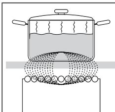
Варочная поверхность оборудована высокоэффективными индукционными конфорками. Тепло образуется непосредственно в дне посуды без промежуточного нагрева конфорки. Таким образом, потребление электроэнергии значительно ниже по сравнению с обычными нагревательными элементами, работающими по принципу излучения.
