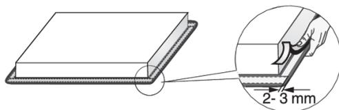
1. Снимите защитную пленку с уплотнителя.
