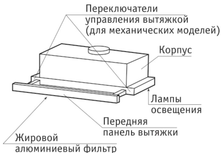
Дополнительными принадлежностями для вытяжки (в комплект не входят), являются угольные запахоулавливающие фильтры (см. рис. ниже). Они применяются для фильтрации воздуха в помещении при работе вытяжки в режиме рециркуляции. Угольные фильтры можно приобрести отдельно у розничного продавца.
