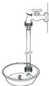
4. Плотно подсоедините шланг к клапану подачи воды у посудомоечной машины рукой, а затем затяните его на 2/3 оборота специальным инструментом.
