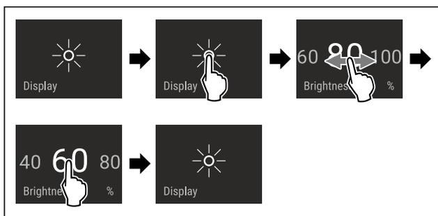
Fig. 40 Примерное изображение: переключение с 80 % на 60 %.
