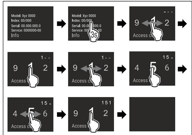
Fig. 4 Примерное изображение, доступ при помощи числового кода **151**
