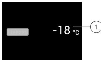
Fig. 6 На индикации статуса отображается фактическая температура.
