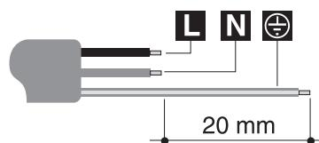
Используйте исключительно кабель типа H05V2V2-F или аналогичный, рассчитанный на максимальную температуру 90°C. Замена должна производиться специалистом, который должен выполнять подключение к сети согласно приведенной ниже схеме.
