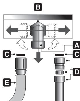
**Подключение с использованием гибкой стальной трубы:** используйте только трубы из нержавеющей стали с неразрезной стенкой, отвечающие всем действующим нормам, всегда пользуясь прокладкой **C** в комплекте поставки между патрубком **A** и шлангом **E**.
