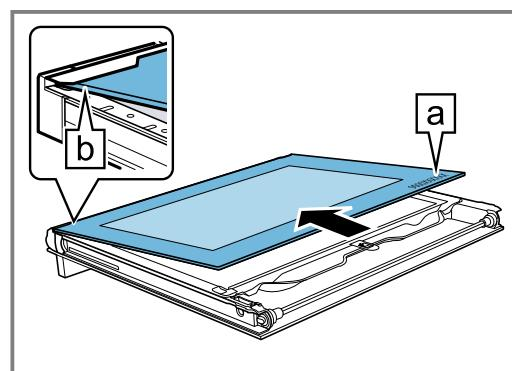
11. Осторожно приподнимите внутреннее стекло вверх под наклоном и установите держатель **a**.
