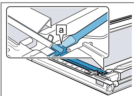
6. Приподнимите рефлектор **b** с помощью отвёртки так ①, чтобы он высвободился, затем поднимите и извлеките ②.
