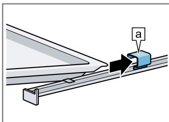
5. Полностью задвиньте принадлежности так, чтобы они не касались дверцы прибора.
