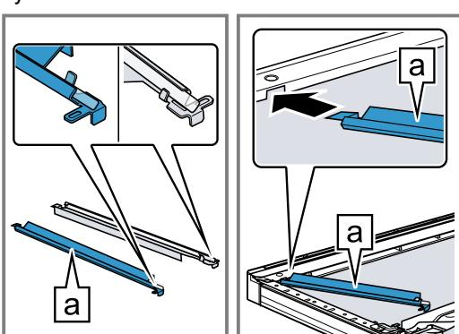
7. Установите рефлектор **a** и зафиксируйте его в разъёме **b**.
