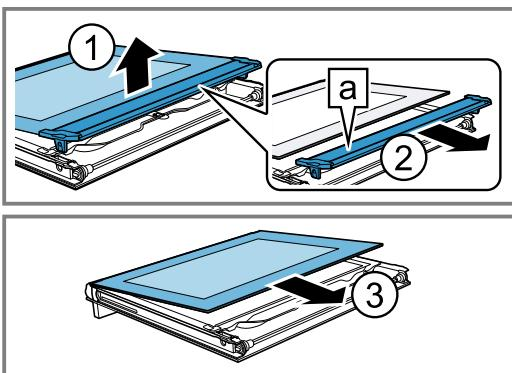
5. Вставьте отвёртку между металлическим язычком **a** и пластиковым элементом.
