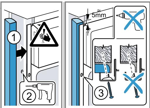
**9. Приоткройте дверцу прибора, установите панели и закрепите их сначала сверху, а затем снизу.**
