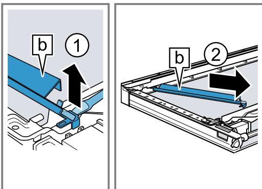
7. Таким же образом снимите второй рефлектор.
