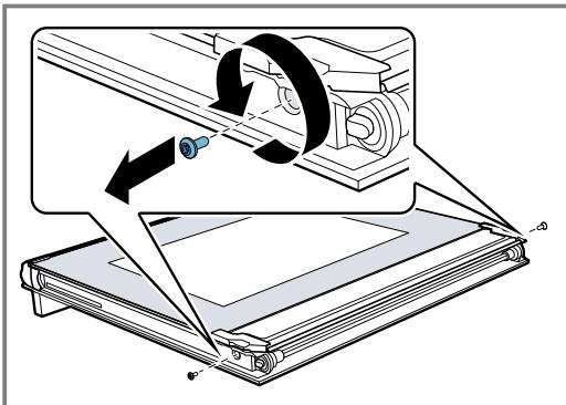
3. Осторожно приподнимите внутреннее стекло вверх под наклоном ① и снимите ② держатель **a**.
