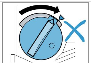
Фиксатор с левой стороны зафиксирован
